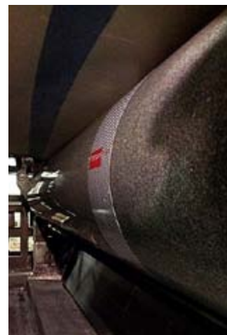
En pressvals där Vasasensors sensorark är fastsatt ovanpå.
