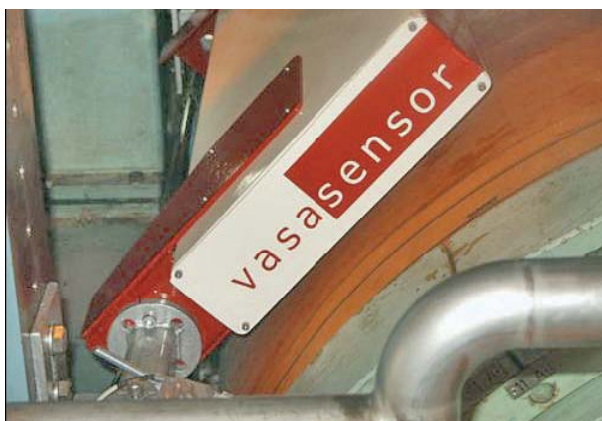
PressEyes mäter tryckprofilen under full drift
